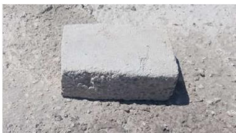
Figura 25 – Calço de argamassa de dimensões 10 cm x 7 cm x 3 cm
